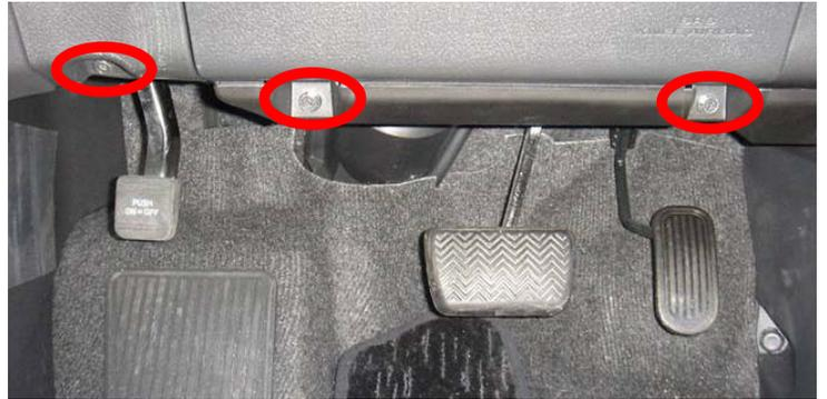
足下のネジを3カ所外し 足下カバーのネジも外しカバーを手前に引っ張り外します
