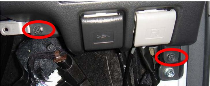
ニアエアバックの下部カバー及び足下カバーを外すし ネジ2カ所外します
